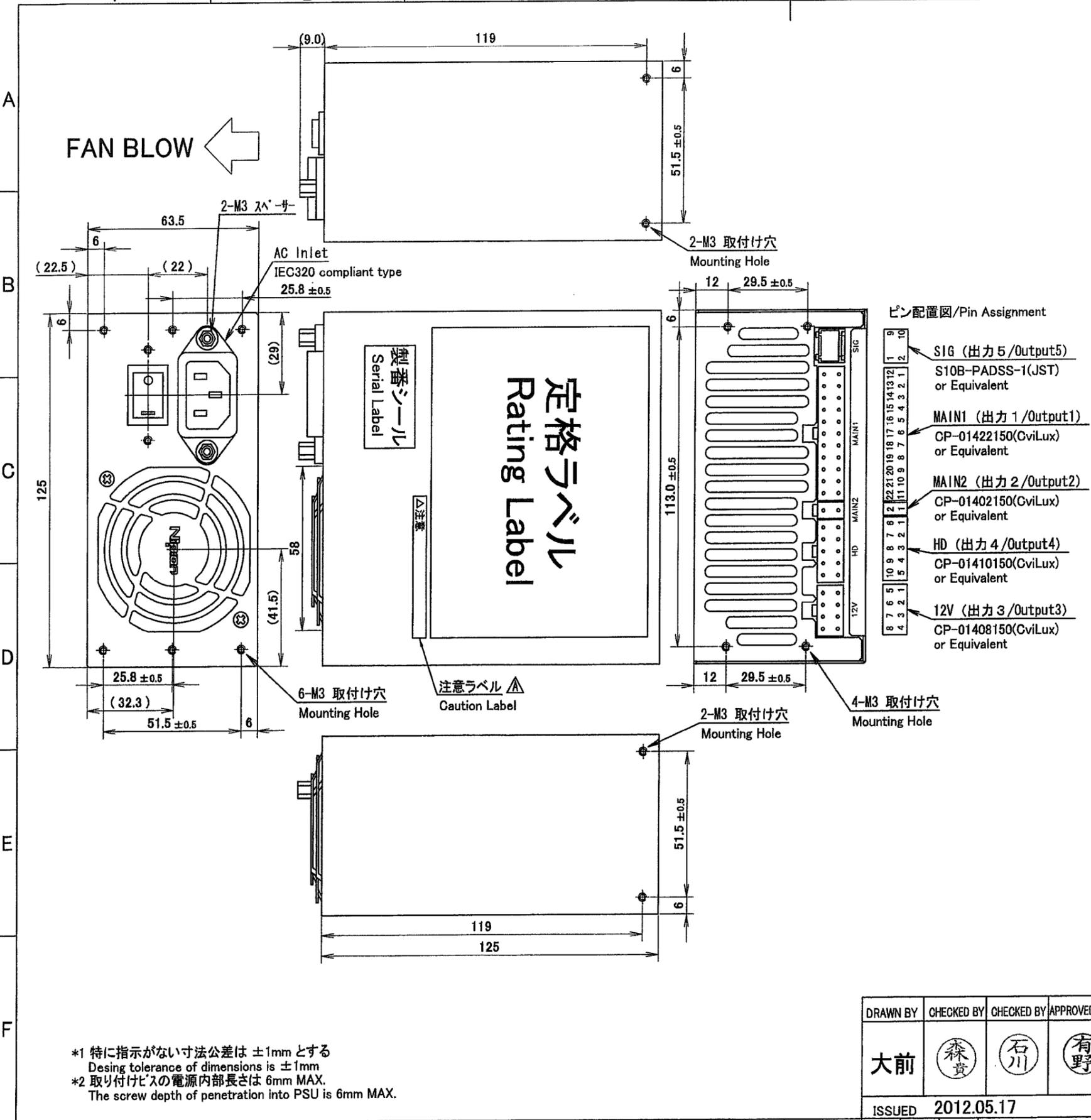
**推奨電源取り付け穴加工図**
